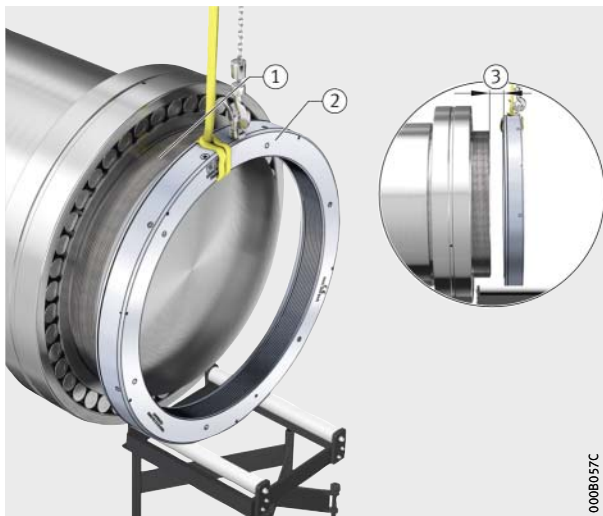
Рисунок 17 Опускание гидравлической гайки
